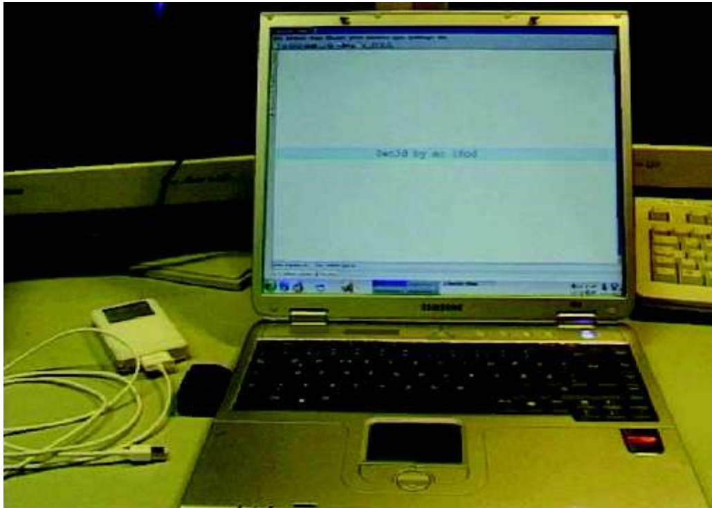
FIG. 4: Modification de la mémoire vidéo depuis un iPod connecté sur un port FireWire (via une carte PCMCIA).
